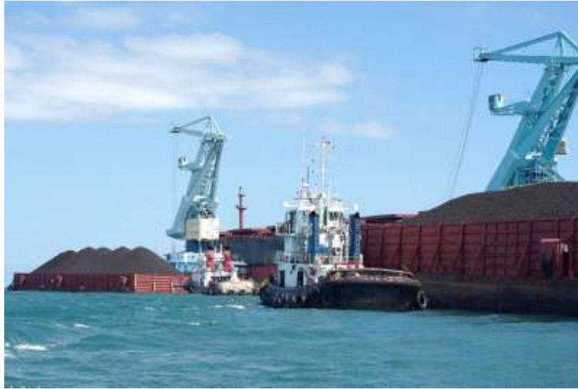
Pemuatan batubara dari tongkang menuju kapal Panamax berkapasitas 80.000 ton dengan menggunakan floating cranes MBP
