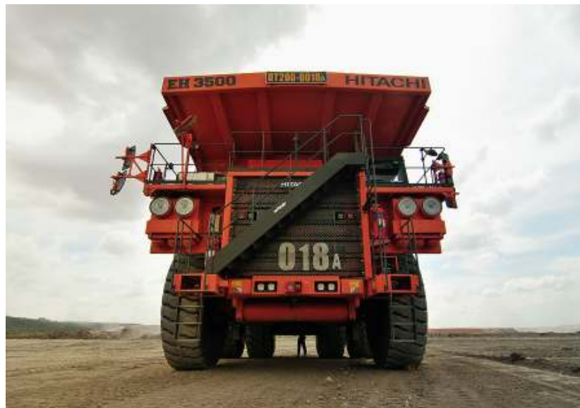
Dump truk lapisan penutup Hitachi EH3500 baru dengan kapasitas 168 ton
