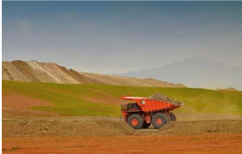
Salah satu dump truk SIS dengan kapasitas angkut 150 ton lapisan penutup ke area penampungan lapisan penutup yang terletak 4-6 km dari tambang
